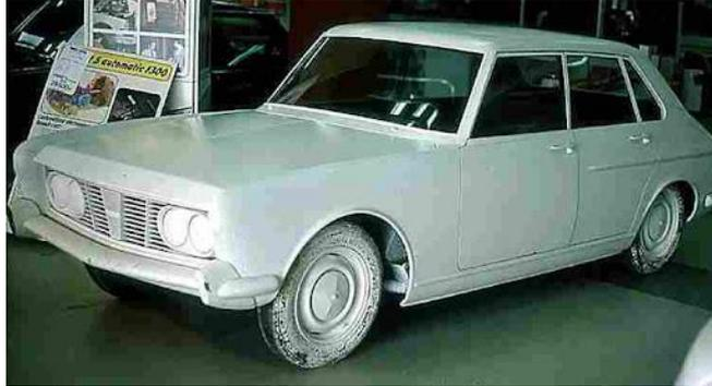
Une maquette qui possède l'ADN de la RENAULT 16, 3 vitres latérales et notamment le passage de roue arrière que l'on retrouve dans le design série mais avec un pare-chocs sans retour sur le côté.
