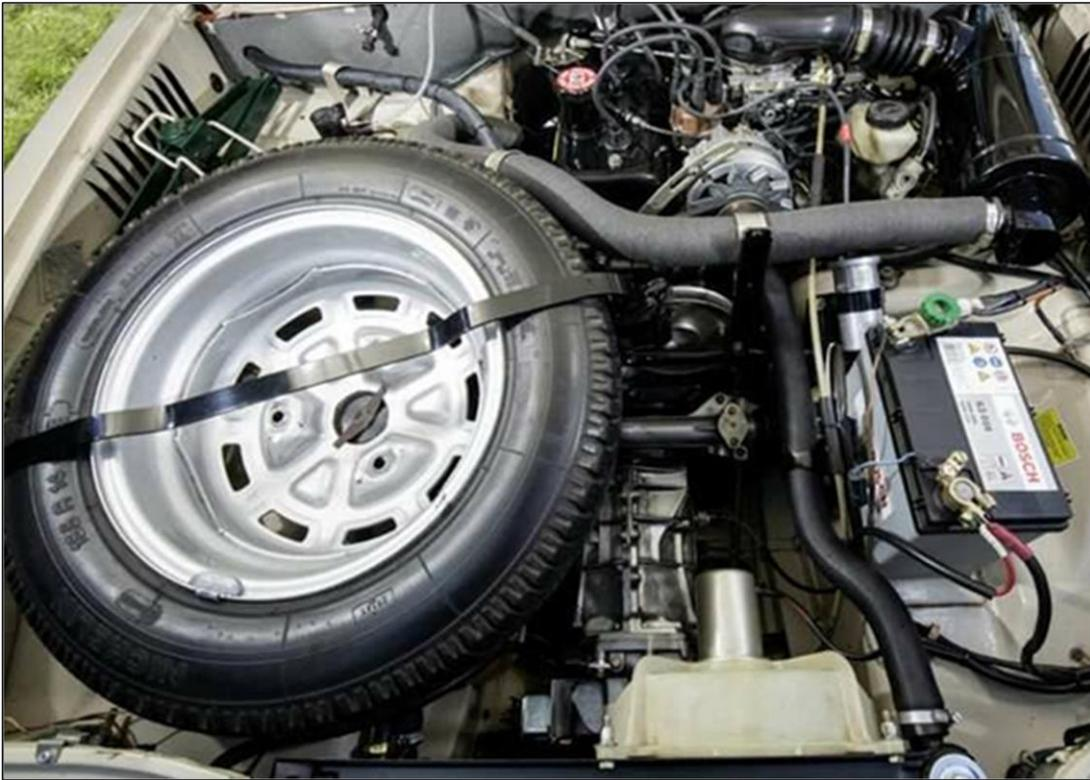
Vue du sous capot version climatisée avec compresseur pour air conditionné.
