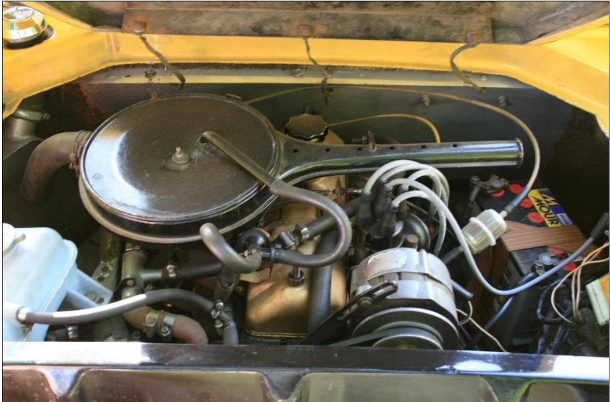
En architecture de voiture sportive, le moteur est en position centrale arrière. Le groupe motopropulseur a fait une rotation de 180° imposant de changer de côté la couronne du couple conique.
