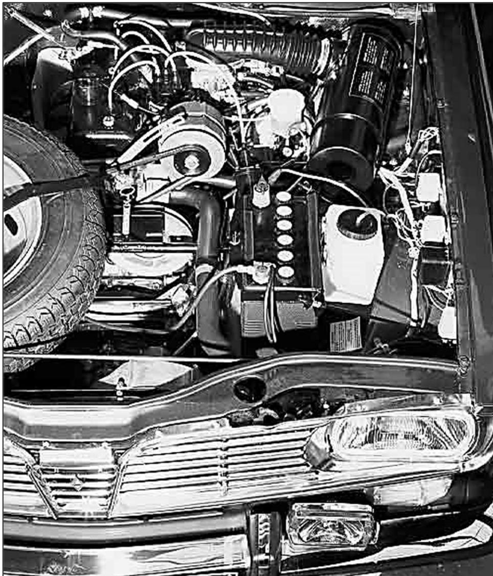
Le 807 est la première application du moteur A de génération 2 avec la cylindrée 1565 cm<sup>3</sup> 77 mm x 84 mm.
